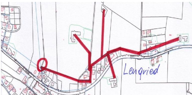
Um Gebiete mit langen Wasserleitungen überwachen zu können, wurden „Sektionszähler“ eingebaut. Bei einer Nachtkontrolle kann sehr einfach überprüft werden, ob durch den Zähler Wasser fließt oder ob das nachfolgende Netz verlustfrei ist. Weiters kann überprüft werden, ob die
